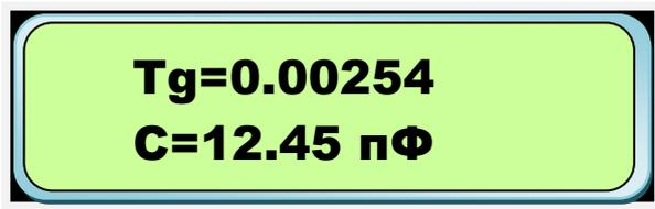
Рисунок 10. Вид экрана модуля индикации «ТАНГЕНС-3М-3-МИ» в режиме измерения тангенса угла диэлектрических потерь и емкости выбранной ячейки.
