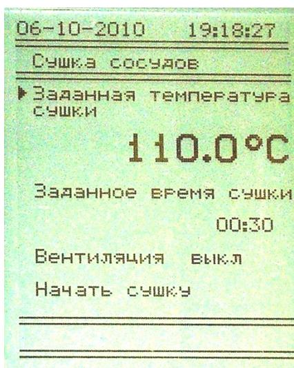
Рис. 11. Вид экрана индикатора в режиме «СУШКА».
