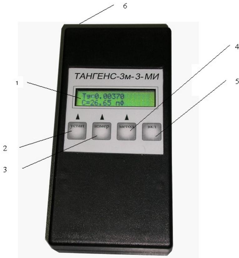
Рисунок 4. Модуль индикации «ТАНГЕНС-3М-3-МИ»:
