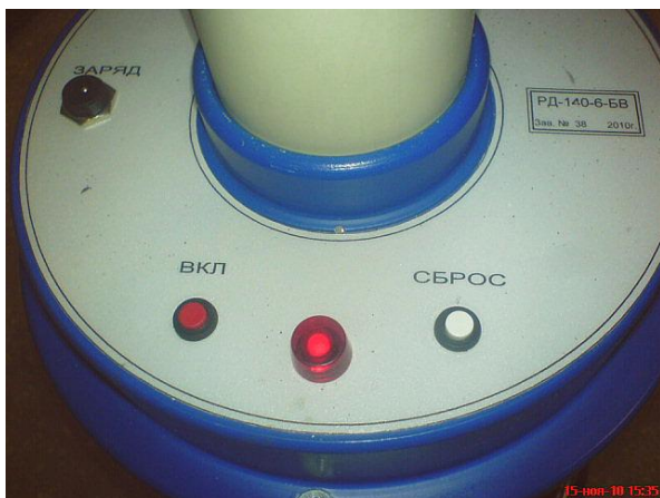
Рисунок 3. Расположение органов управления в РД140-БВ
